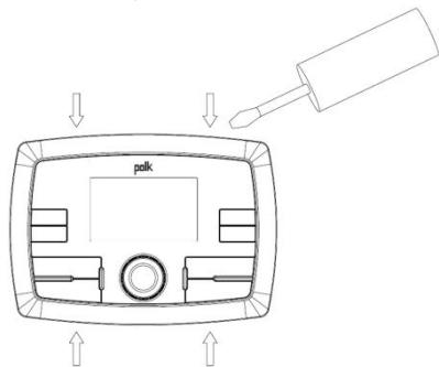
2. Utilizar los tornillos con la longitud más corta posible, montar el sintonizador/amplificador como se detalla en el diagrama de la derecha.
