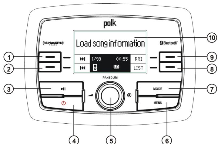
Para ingresar al modo iPod desde cualquier otra fuente, presione el botón **MODE** (7) y seleccione la tecla **USB**. Si el usuario conecta un iPod sin tener canciones, la radio mostrará el siguiente mensaje “Sin Canciones” cuando ingrese al modo iPod.
