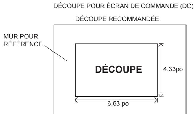
**REMARQUE :** Avant de couper le trou de montage, veuillez-vous assurer que la zone derrière l'emplacement est loin des câbles électriques, des conduits d'essence et d'aération ou d'eau; assurez-vous de laisser un espace d'au moins 2,75 po derrière l'écran de commande pour permettre une programmation par clé USB.
