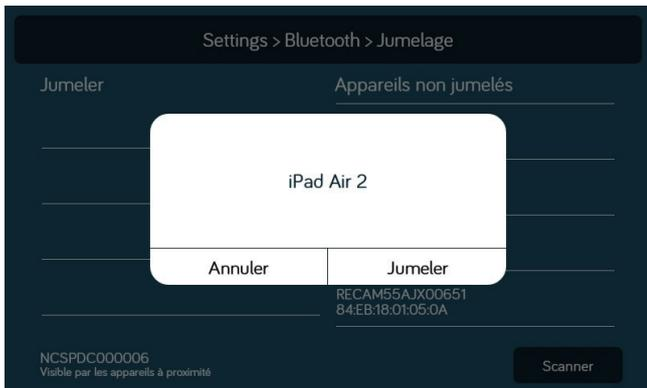
2.5. Une demande de jumelage Bluetooth va s'afficher sur le DC et l'appareil mobile.
