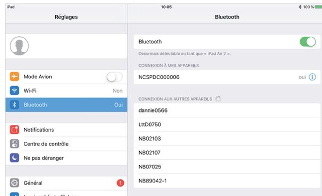
2.9 Le DC va s'afficher sur la liste de l'appareil mobile au format « NCSPDCXXXXX ». Appuyez sur le DC sur l'appareil mobile pour le connecter avec.
