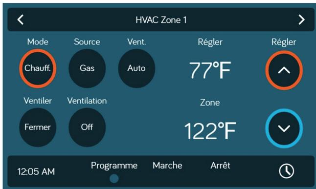
2. Appuyez sur le bouton « Source » pour choisir entre gaz ou électrique. (Les sources de chauffage dépendent du plan de sol)
