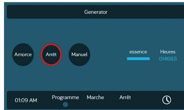
3. Si la tension de la batterie est inférieure à 11,8 volts pendant 3 minutes, le système démarrera le générateur.
